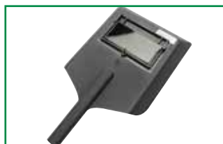
HÅNDSKÆRM Lille, let håndskærm i PVC. Svejseglass: 51 x 108 mm. Leveres med DIN 10 svejseglass.
