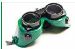
SVEJSE-/SLIBEBRILLE Kombineret svejse- og slibebrille med runde glas i carborock. Slibebrillen er fast, mens svejsbrillen kan vippe. Flere muligheder for isætning af glas alt efter behov og anvendelse. Anvender glas i ø50 mm.
